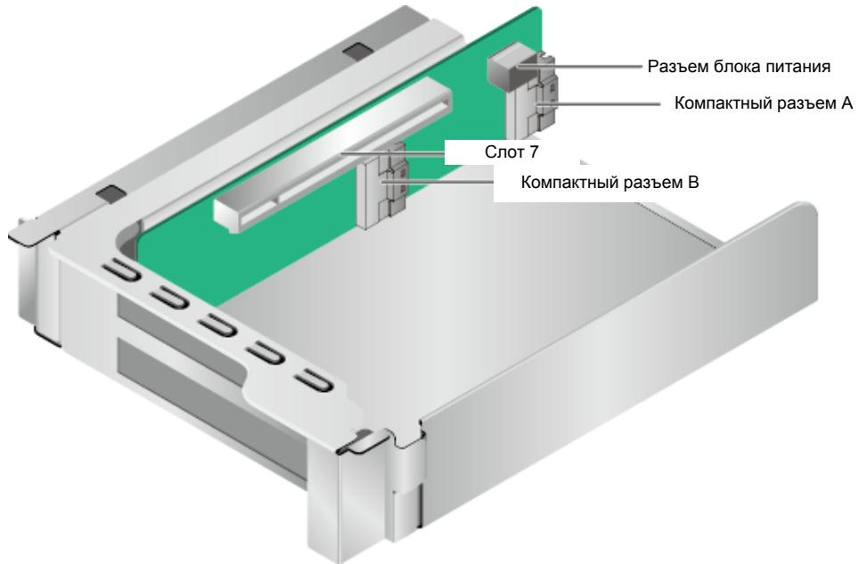
На Рис. 4-24 показаны слоты PCIe, расположенные на задней панели.
